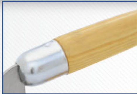
Cabo encerado con casquillo de metal reforzado, ensamblado con resina epoxica para mayor resistencia a la extracción
